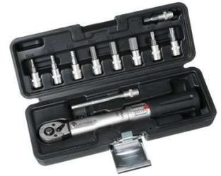
*Figure 20 Clé dynamométrique*
