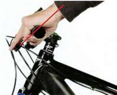
Figure 31 inclinaison du levier de frein
