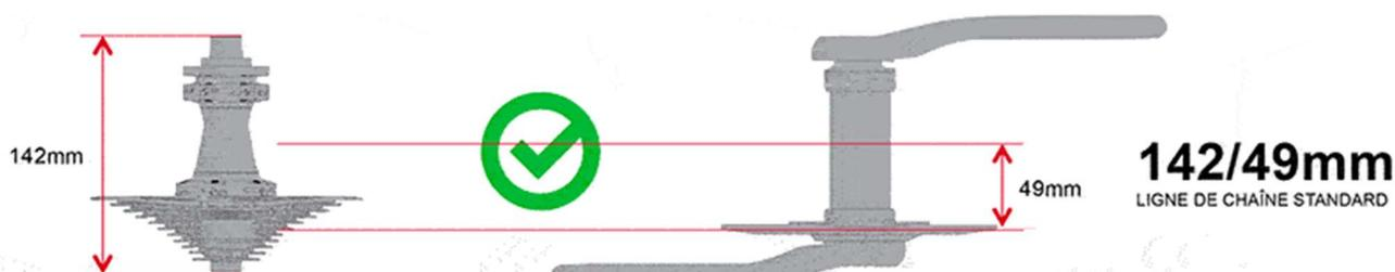
Bien entendu, le fait de changer la largeur du moyeu arrière influence directement le cadre du vélo qui doit accepter les nouveaux moyeux. Le boîtier de pédalier doit également être élargi de 3 mm et, en conséquence, le pédalier lui-même qui a dû être repoussé vers l'extérieur.
