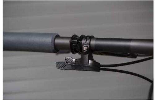
Figure 9 Blocage de suspension
