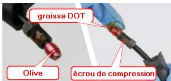
Ensuite, l'écrou de compression est vissé (5 Nm) sur le levier en comprimant l'olive. C'est ce qui assure une parfaite étanchéité du circuit de freinage.
